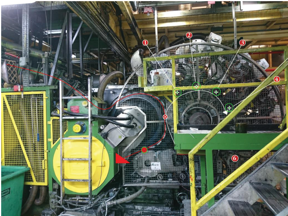
Figur 1: Färgläggningsmaskin av aluminiumburkar där röd linje motsvarar burkarnas rörelse genom maskinen.
