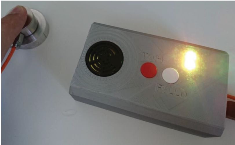
Figur 24: Gula dioder indikerar en kvarande vikt mellan 50% och 30% av pålagd vikt.
