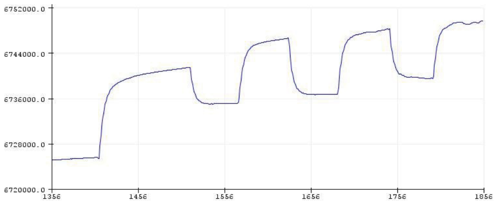
Figur 33: Inspänd framifrån och insmord kista som avlastats fyra gånger.
