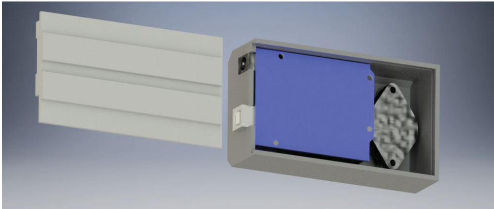
Figur 16: Elektroniskal bakifrån med elektroniken monterad.
