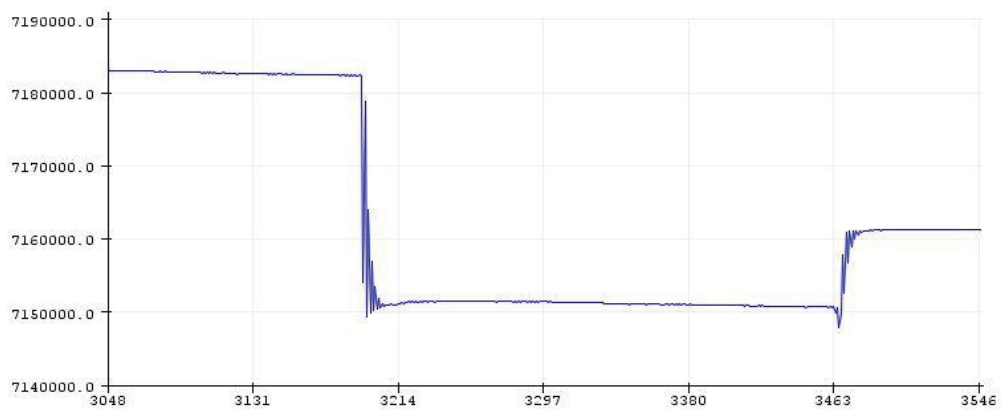
Figur 31: Avlästa värden då fritt pålagd kista lastas och avlastas med muttrar
