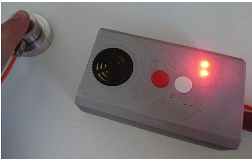
Figur 25: Röda dioder indikerar en kvarvarande vikt mellan 30% och 20% av pålagd vikt.
