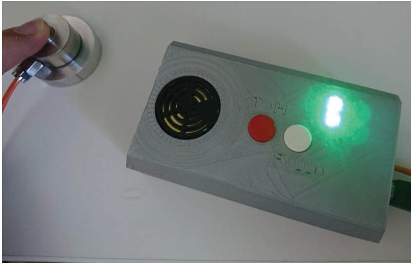
Figur 23: Gröna dioder indikerar en kvarvarande vikt mellan 100% och 50% av pålagd vikt.
