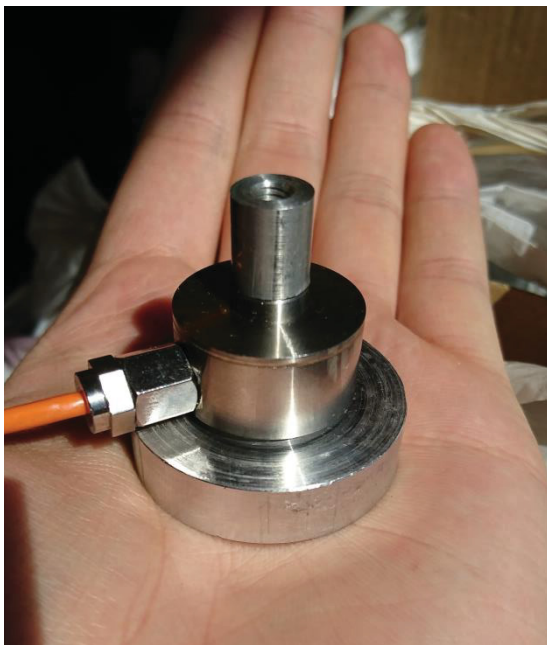
Figur 26: Tillverkad monteringsanordning för provisoriskt test av lastcell under färgkistan.
