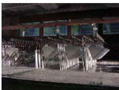
Godset har här doppats och är på väg upp ur den varma zinkgrytan.
