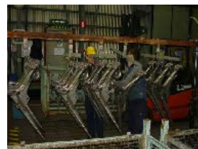
Stora detaljer galvaniseras ibland. Det blir tunga lyft och knepig arbetsmoment.
