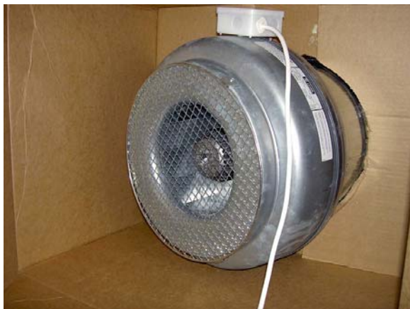
Fig. 1 Fläkten i början av systemet
