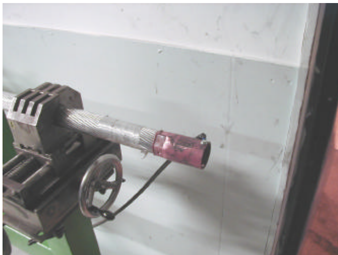
Figur 20: Figuren visar hur strömmen ansluts på hylsan som är pressade runt ledaren.
