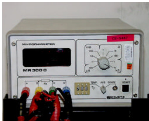
Figur 12: Bild på Schuetz mikroohmmeter som används i den stationära mätbryggan.
