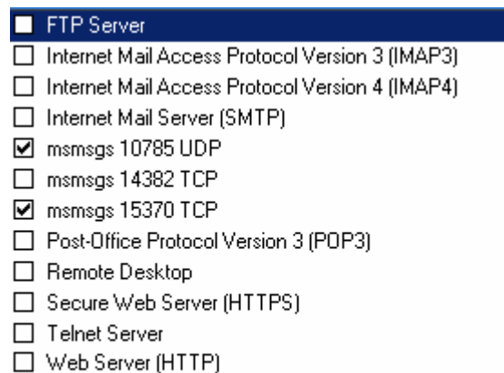
figur 3. Automatiskt öppnande av portar i ICF.
