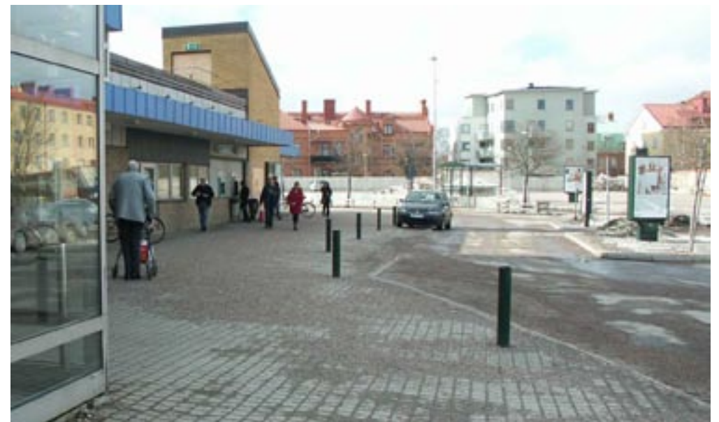
Platsen närmast väggen skyddar besökarna från fordon med hjälp av markbeläggningen och pollarna
