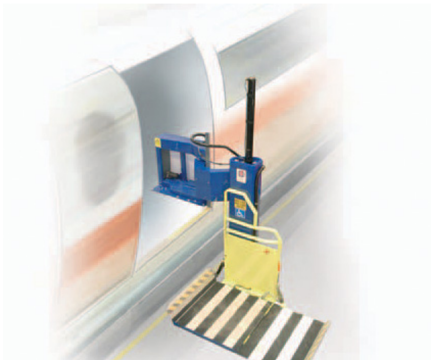
Figur 19 Lift i position med perrong [29]
