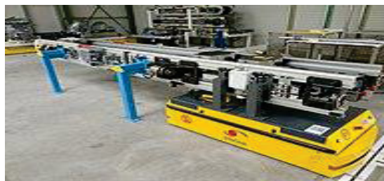
Figur 19 Figur 15. AVG installerad inom fordonsindustri
