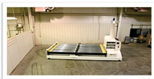
Figur 14 Figur 10 Automatisk styrda fordon (AGV) med drivna rullar (foto hämtad från www.Egemin-automation.com )
