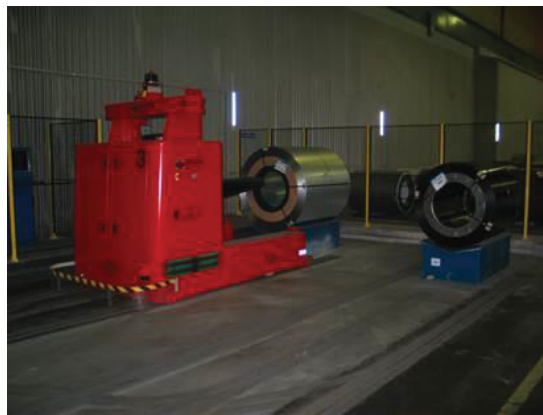
Figur 31 Referensbild, SOLVING 15 t pik-AGV på SSAB (Borlänge)
