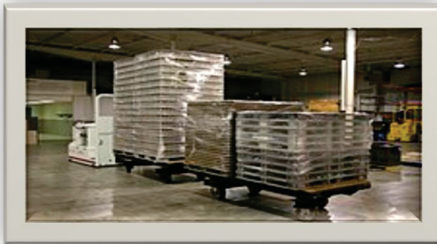
Figur 15 Figur 11. Pallhantering med automatiskt styrt fordon (AGV) (foto hämtad från www.Egemin-automation.com )
