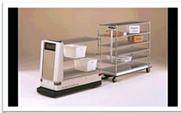
Figur 17 Figur 13. Light Load Automatiskt styrta fordon (AGV) (foto hämtad från www.egemin.hemsida )
