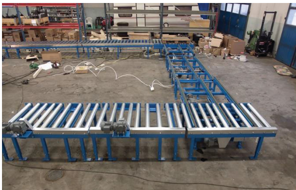
Figur 33 Kombinationslösning med roll och kedjabana
