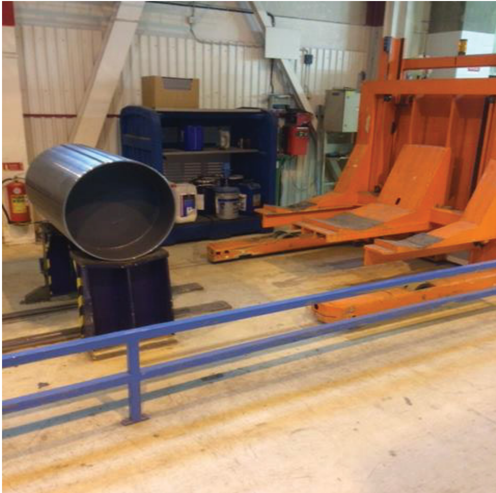
Figur 7 AGV trucken klar för upphämtning av valsen
