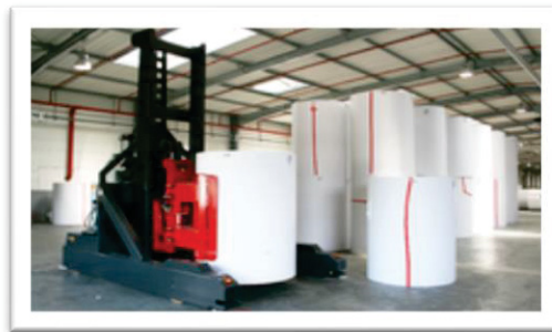
Figur 18 Figur 14. Automatiskt styrt fordon (AGV) används för hantering av pappersrulle (foto hämtad från www.egemin-automation.com )
