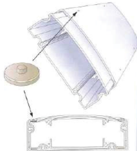
Plasthjul , som finns i den yttre profilen, fungerar som distans och ger en mjuk, glappfri teleskopering.
