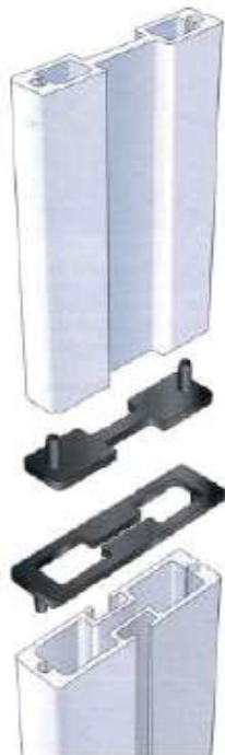
Vid teleskopande funktioner används ofta plastdetaljer i ändarna för att erbjuda mjuka och ljudlösa rörelser. Höjdinställningen kan regleras stegfritt med en mutter eller gängad plattstång som löper i ett mutterspår. Vid sidogängning (Bess höjden och eventuell glappföreslirner.
