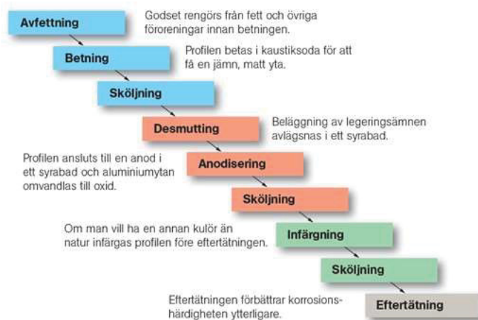
Bild 40 Anodiseringsprocessen
