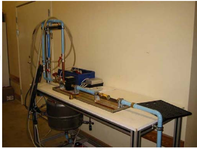
Figur 4 t.v. visar ett exempel på hur en flödesmätare kan se ut. Figur 5 t.h. visar testbänken där ett enkelt funktionstest på flödesmätare kan utföras.
